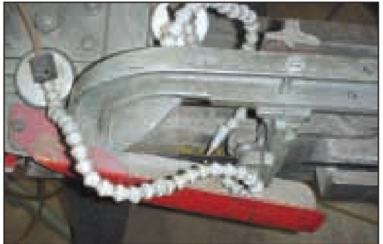
Lubricación de cantidad mínima usada en una sierra horizontal
