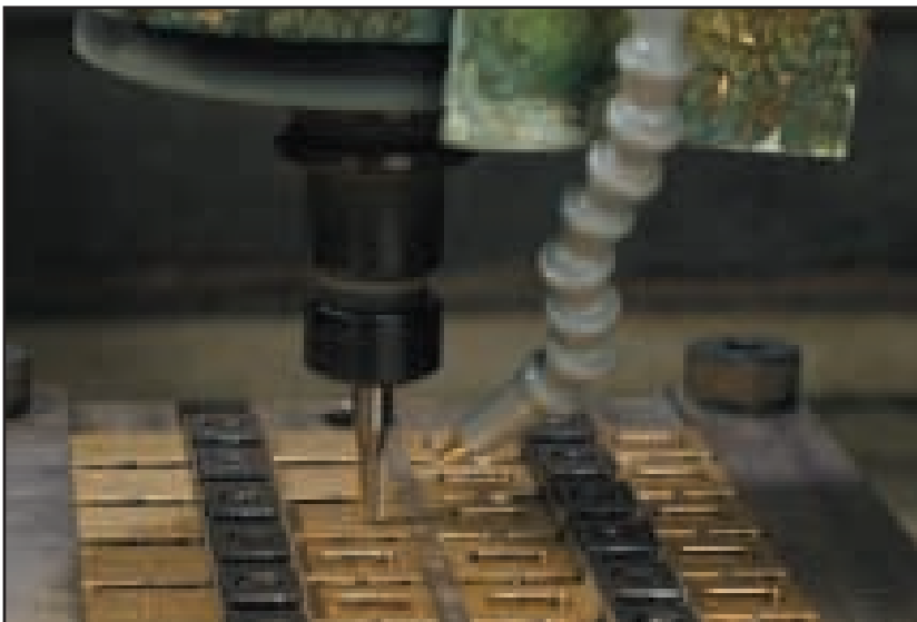
Lubricación de cantidad mínima usada durante una operación de mecanizado
