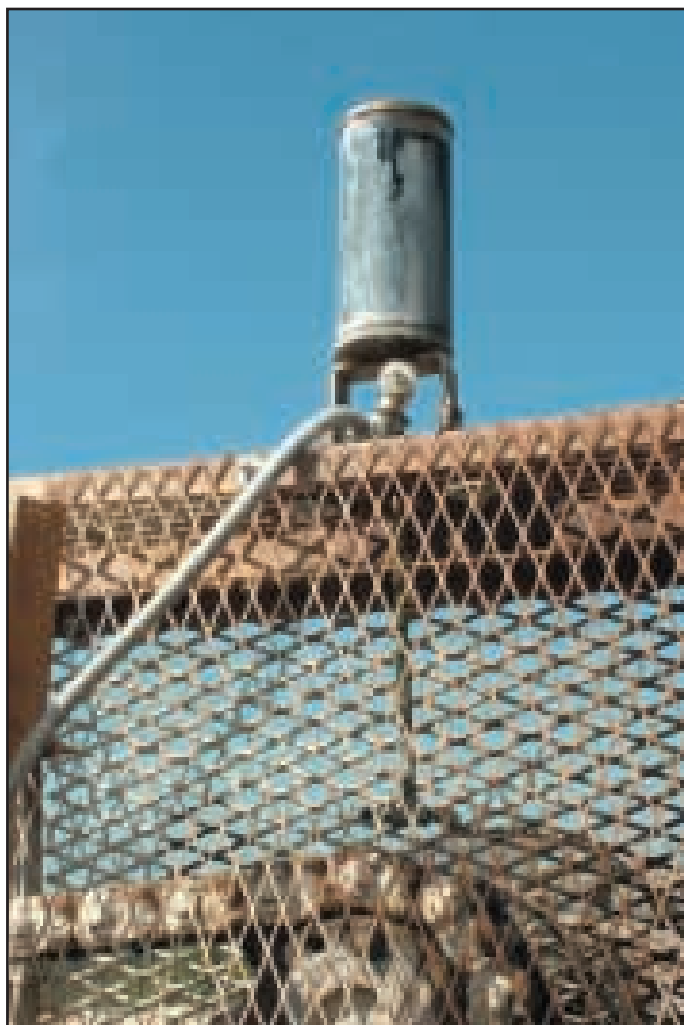
La aceitera de cadena lubricando una cadena en una pantalla de colección de basura
